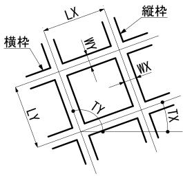
※ 角度は 水平線を基準に反時計回りを正(+)とする。
